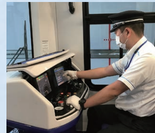
列車出庫時の点検
